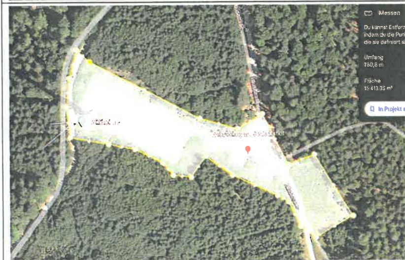
Abb. 8: Windturbine im Wald (gleicher Windpark wie Abb. 7) → benötigte Landfläche: 15'413 m²
